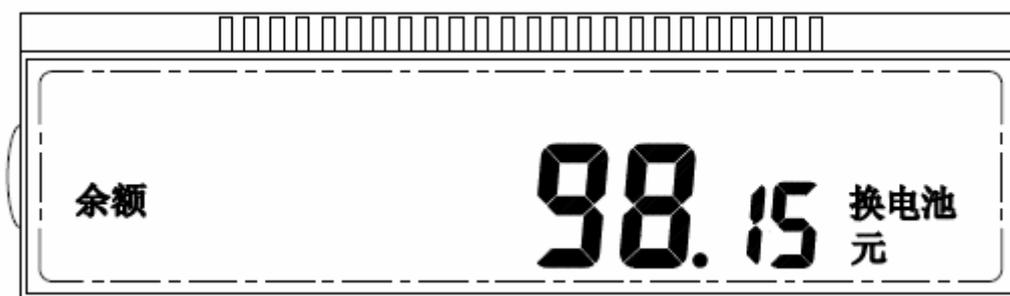
更换电池后，将阶梯用户卡插入表中，即可开阀；推荐使用五号碱性电池作为系统电源，以避免普通电池漏液对仪表的损坏。
